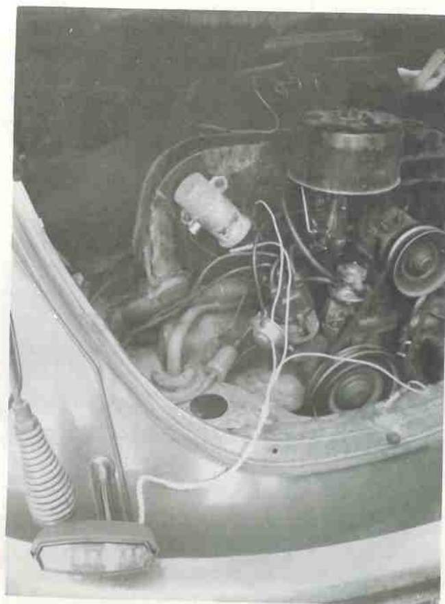
Conta-giros instalado para medição
