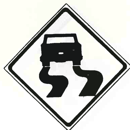
A_28 Pista Escorregadia
